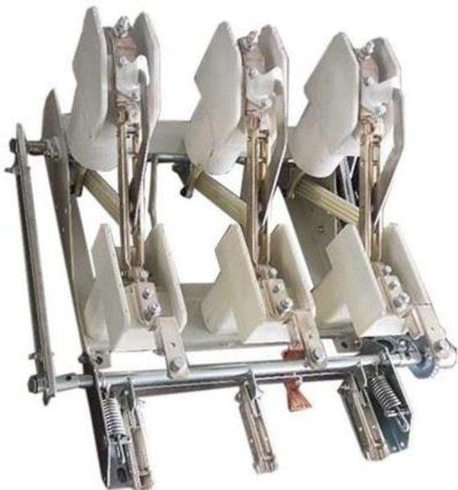
Выключатель нагрузки FN18-12D сочетает в себе преимущества выключателя нагрузки и предохранителя, обеспечивает контроль всего диапазона перегрузки и тока короткого замыкания. Могут применяться для коммутации и защиты силовых трансформаторов, двигателей и конденсаторных батарей.
