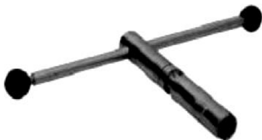
Рукоятка для оперирования разъединителем в шкафах типа V
